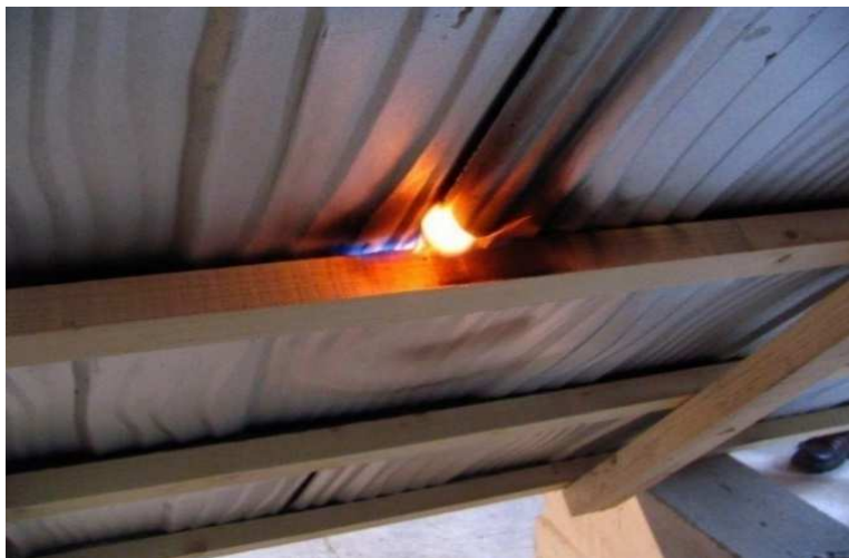
Risba 10a: Prikaz požarne ločitve na stiku strehe z zidcem več kot 30 cm nad streho
